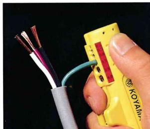
ゲージサイズに合った刃部の所で皮むきをして下さい。
