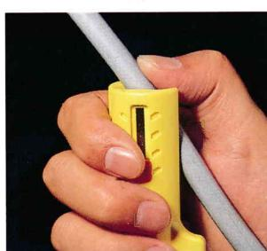
ケーブルをたてに裂く場合、たて切りカッター部にケーブルを乗せ、親指で強く押えて引張って下さい。
